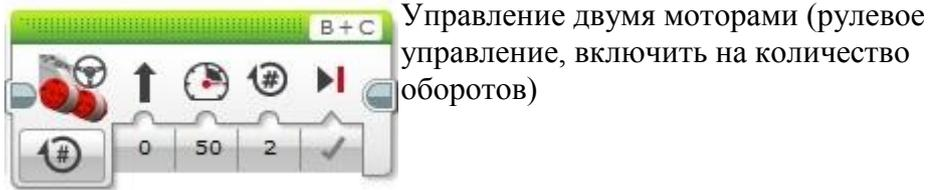
Управление двумя моторами (рулевое управление, включить на количество оборотов)
